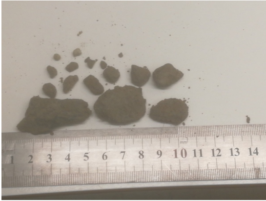
Fjernet gruskorn fra prøven før konusforsøk
