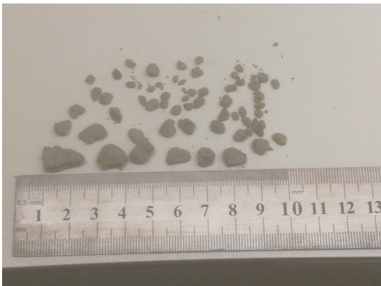
Fjernet gruskorn fra prøven før konusforsøk
