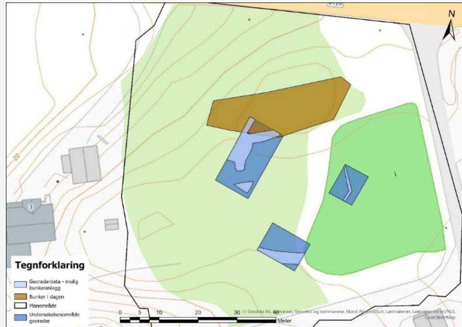
Figur 17: Tolkningen av påviste reflekterende flater (strukturer) i undergrunnen i Kalvehagen. De to vestre gridene (grid 1 og 2) kan vise deler av bunkeranlegget mens det østre trolig viser en kabel eller et lite rør.
