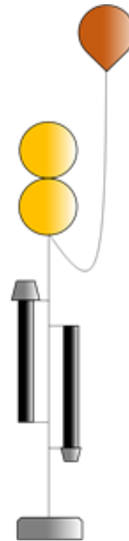
Figur 3 Prinsippskisse av strømmålerigg. AquaDopp Profiler måler oppover i vannsøylen, med ekstra punktmålere som peker nedover. Modifisert skisse fra NS 9424-1:1999. Merk at på rigg brukt i felt var det påmontert ekstra punktmåler og alle målere var vendt opp.
